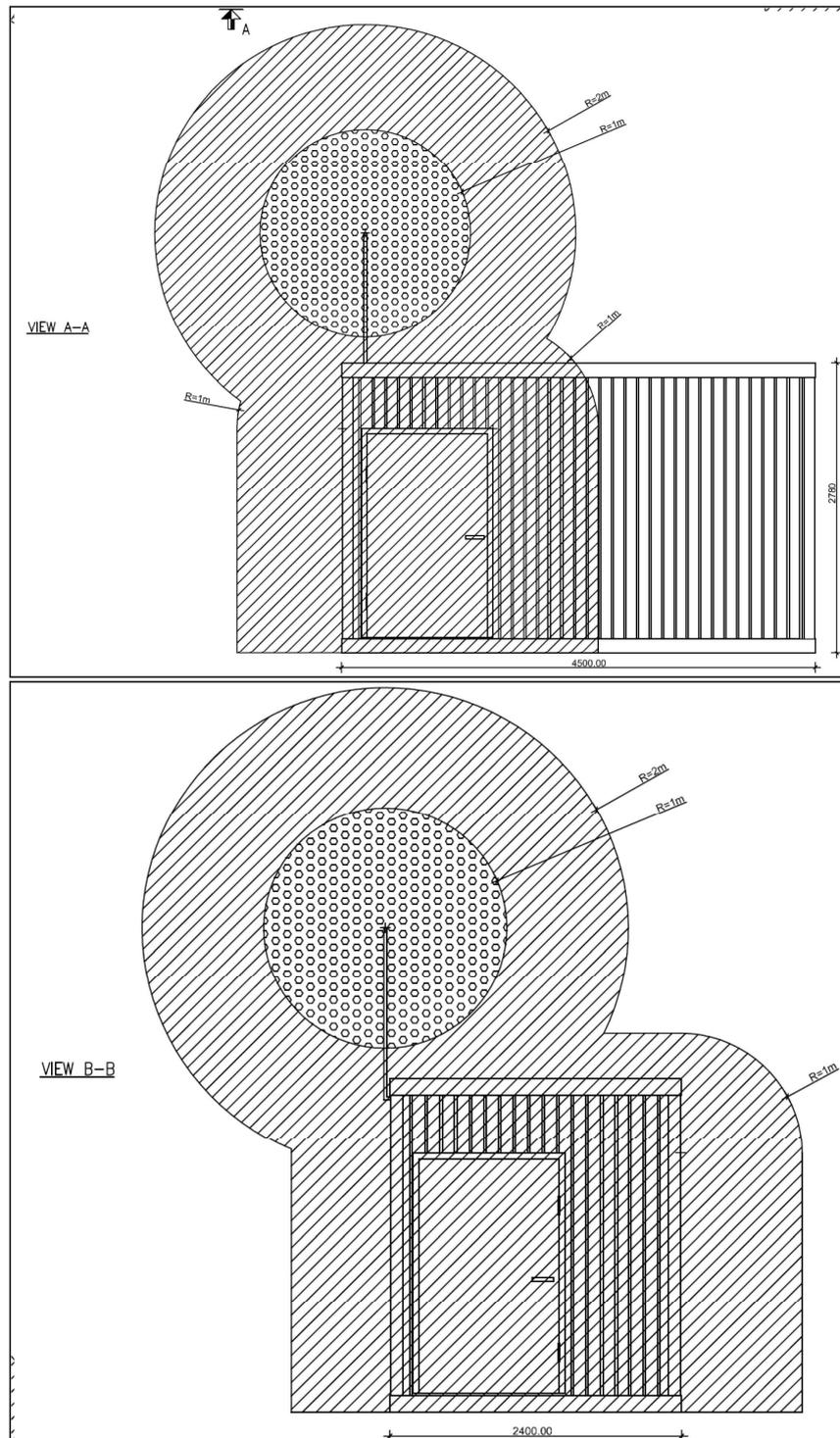
Figure 45 : Zonage ATEX du poste d'injection (Gestionnaire de réseau de gaz)
